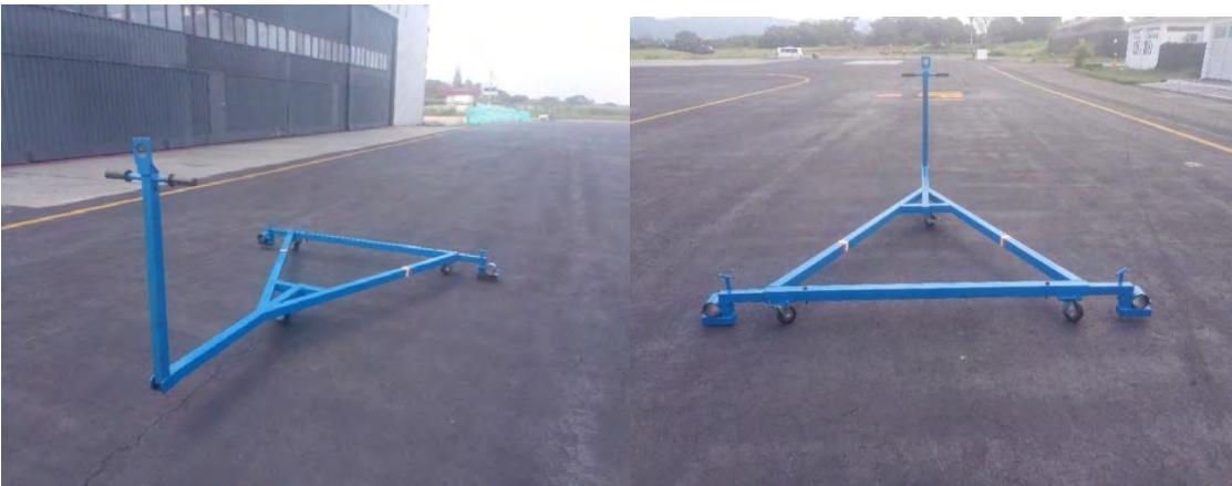
Figura 28 Presentación prototipo para el transporte en tierra de Helicópteros Bell Ranger 206 ya terminado, fuente: Elaboración Propia
